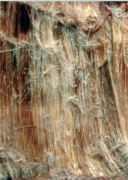
Fibras de amianto
